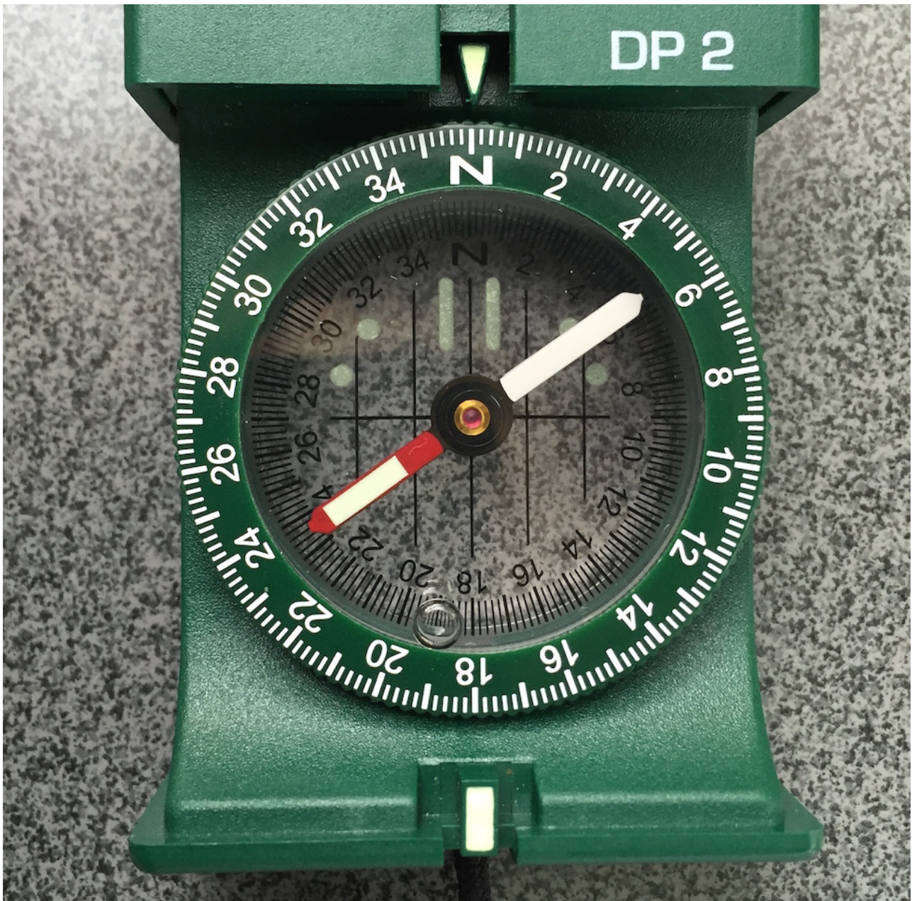
Abbildung 18. Die Nordmarkierung zeigt in Visierrichtung, am Kompassboden sind die Linienmarkierungen erkennbar.
