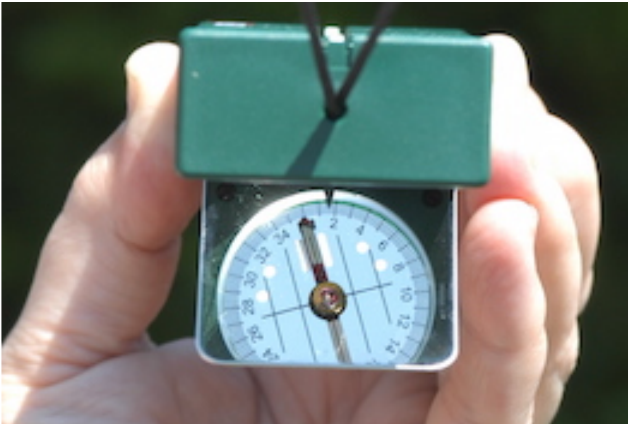
Abbildung 22. Die Kompassnadel liegt mit der Nordmarkierung über der Nordmarkierung des Kompassgehäuses und die Visiereinrichtung des Kompasses ist nun auf 18^\circ eingestellt.
