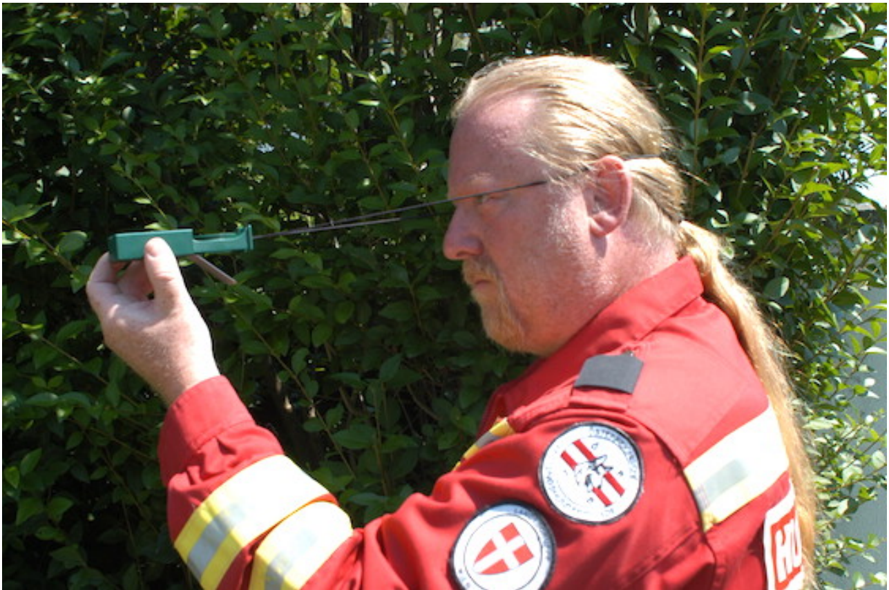
Abbildung 21. Visieren mit dem Kompass.
