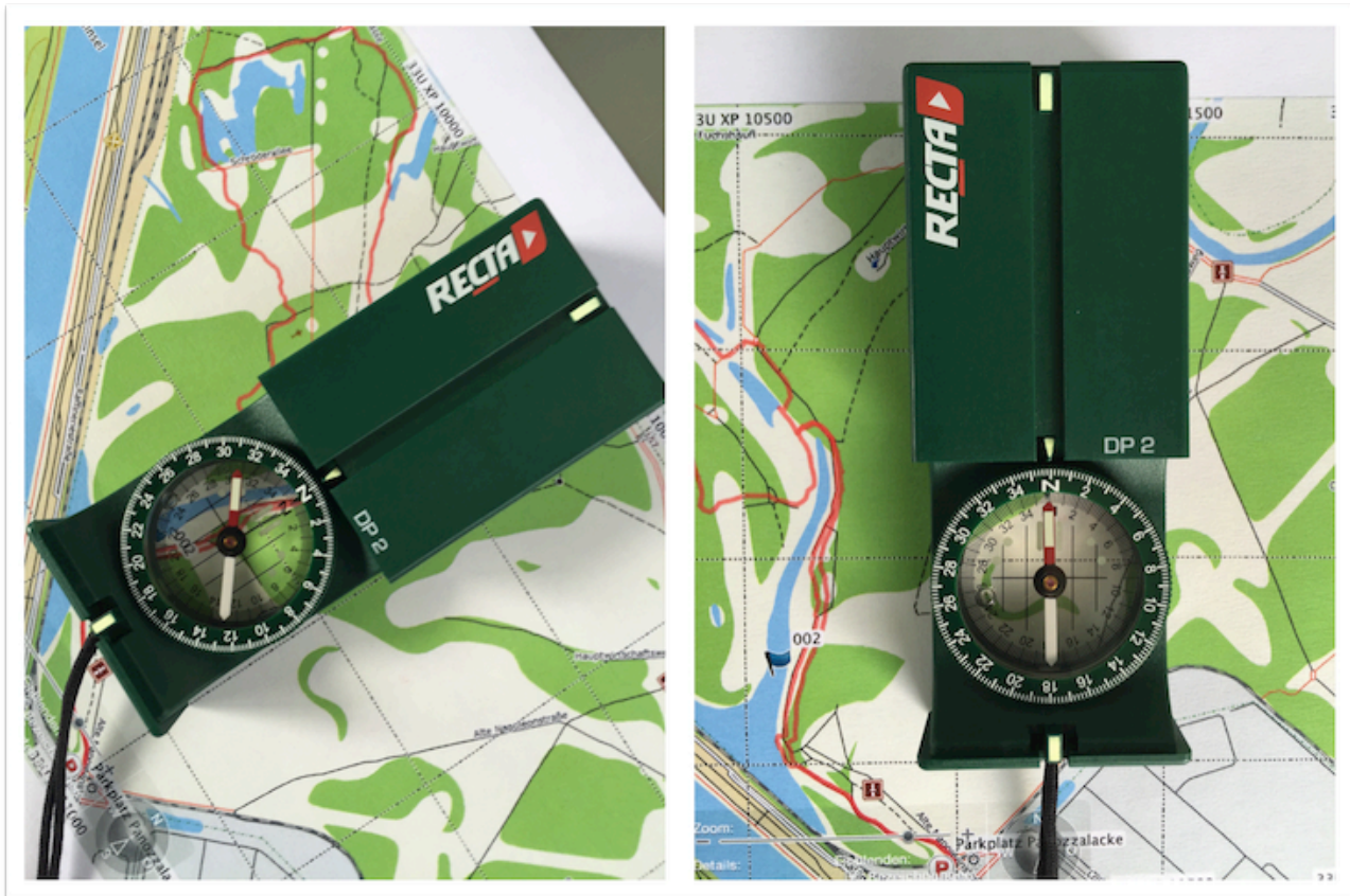
Abbildung 19. Der linke Teil der Abbildung zeigt, dass die Linienmarkierungen am Kompassboden mit den Gitterlinien der Karte einander parallel sind. Weiters ist erkennbar, dass die Anlegekante des Kompassgehäuses mit der vertikalen Gitterlinie der Karte übereinstimmt. Im rechten Teil der Abbildung wurde die Karte samt Kompass so lange gedreht bis der Kompasszeiger exakt über der Nordmarkierung liegt.
